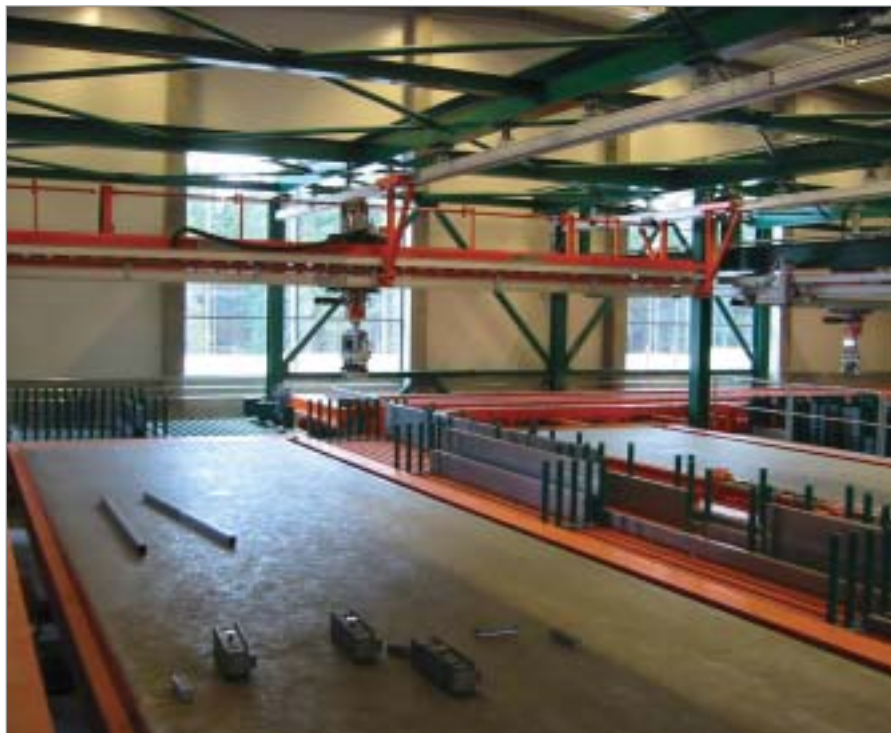
Schalungsroboter und Magazinroboter während der Inbetriebnahme
