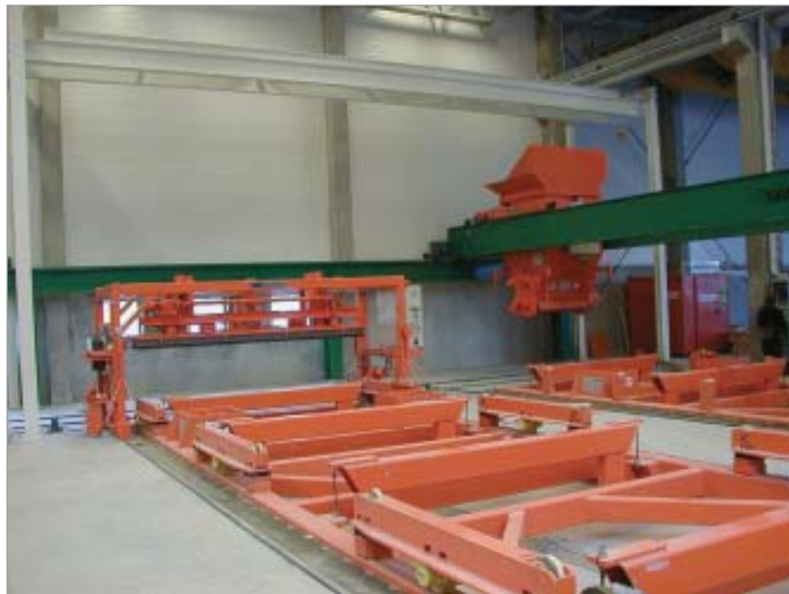
Verdichtungsstationen, Betonverteiler und Tandemglätter
