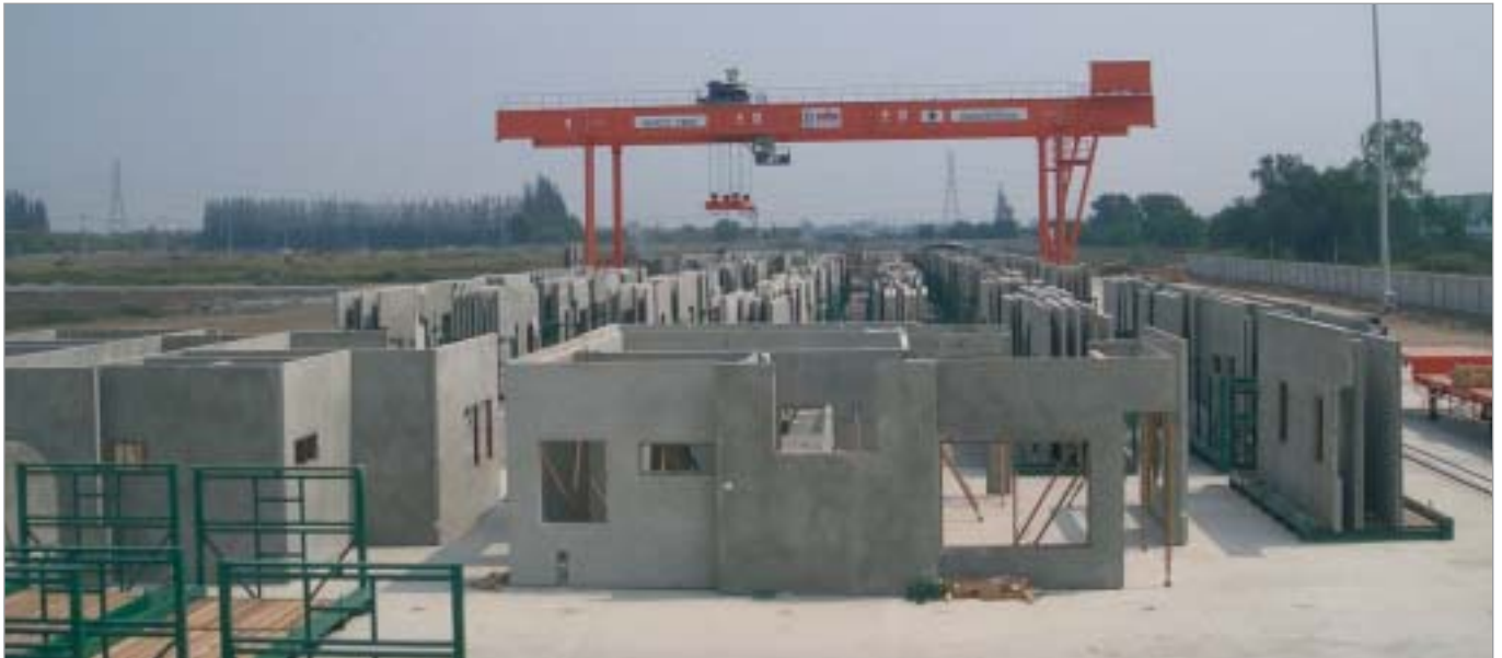
Rund 110.000 m 2 Wandelemente sollen später in dem neuen Werk monatlich produziert werden
